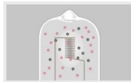
Moléculas halógenas previenen el ennegrecimiento
