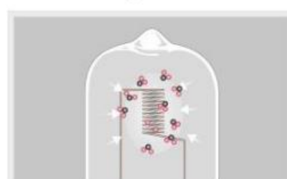
Halógenos llevan las partículas de tungsteno al filamento
